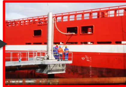
LNG fixed bunkering
